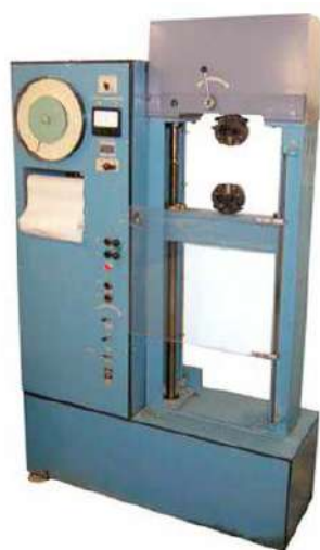
Рис 1. Внешний вид разрывной машины марки 2099P-5 с электрическим приводом активного захвата и электронным силоизмерителем.
